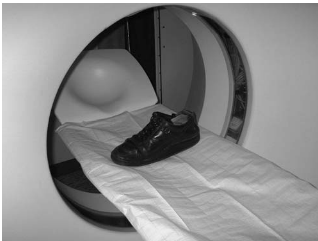
Abb. 1 Messanordnung zur computertomographischen Aufnahme primärer sagittaler Schichten des Schuhinnenraumes
